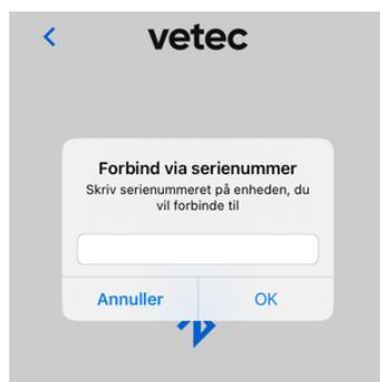
Geben Sie die Seriennummer des Dynamometers ein. Ihr Telefon wird automatisch mit dem Dynamometer gekoppelt und merkt sich die Verbindung für die zukünftige Nutzung.
